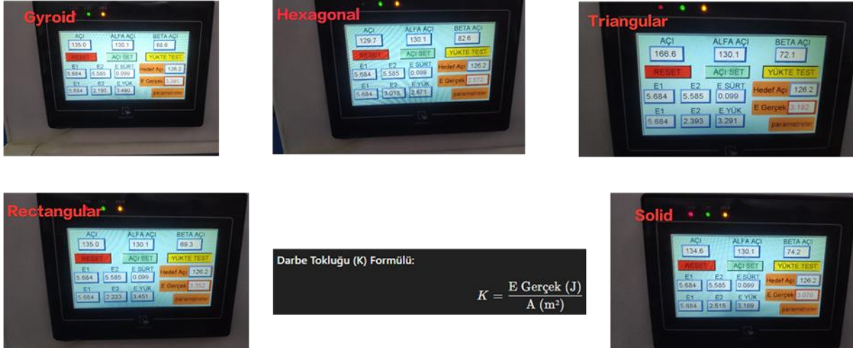
Şekil 2. Darbe testi numunelerin dayanım özellikleri
