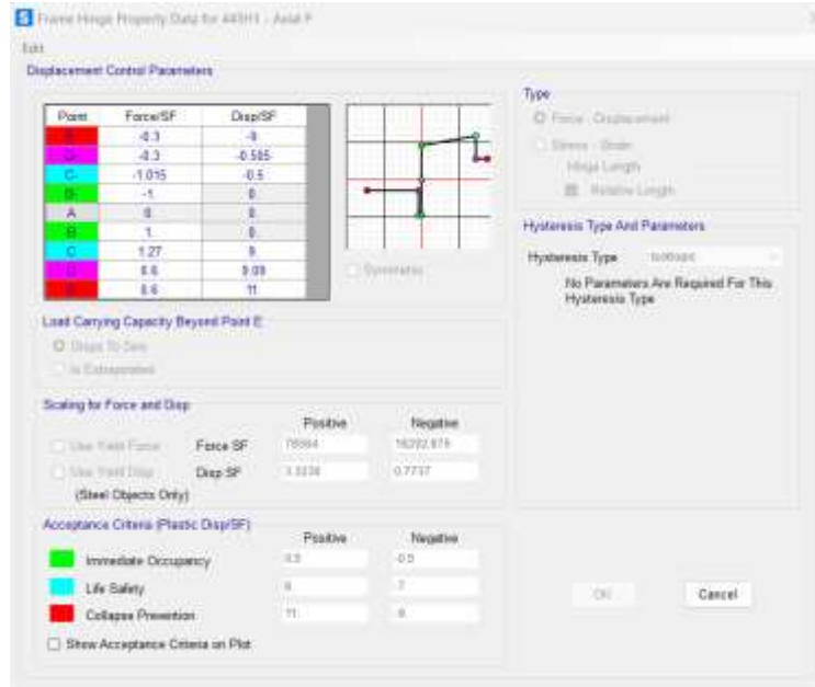
Şekil 20 Çapraz kirişi eksenel yük plastik mafsalları tanımlaması
