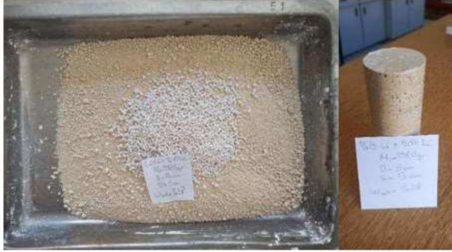
Şekil 10 %15 (hacimce) genişletilmiş cam granüller içeren karışım numunesi.
