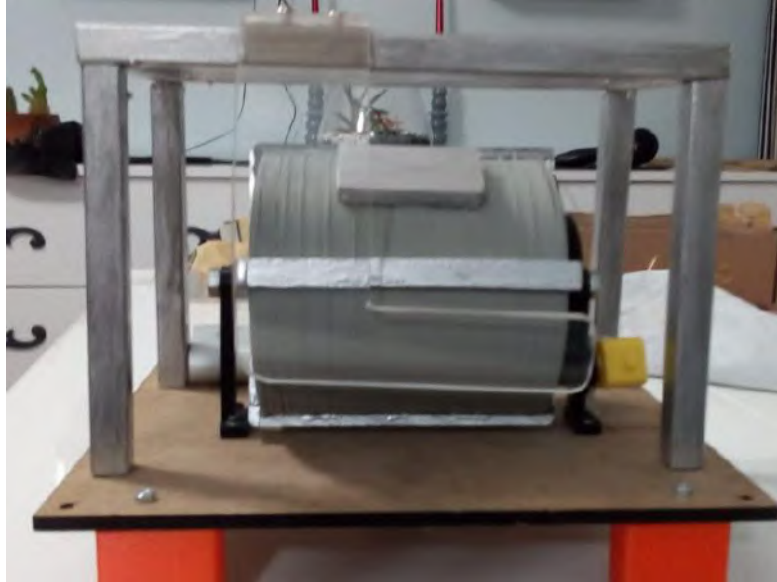
Şekil 1-Yeni Nesil Deri İşleme Dolabının CNC ile Yapılmış Dinamik Modeli
