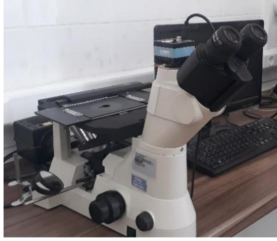
Şekil 2.1. (a) Nikon Eclipse MA100 ters metal mikroskobu, (b) Metkon Duroline-M sertlik ölçüm cihazı
