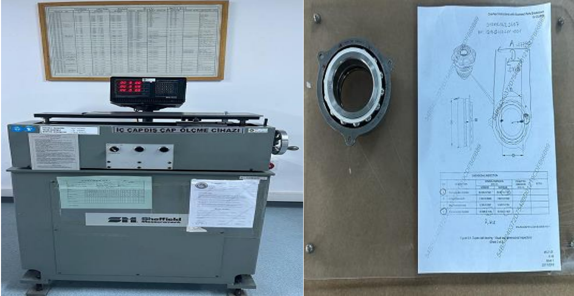
Şekil 7. İç ve dış çap ölçme test cihazı ve ölçüm sonuçları
