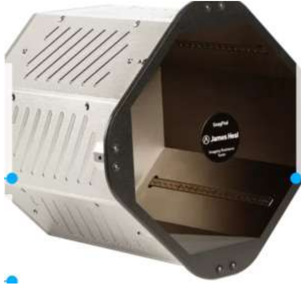
Şekil 6. SnagPod- iğneli hasırdan oluşan iplik çekilmesi kutusu- (James Heal, 2025)
