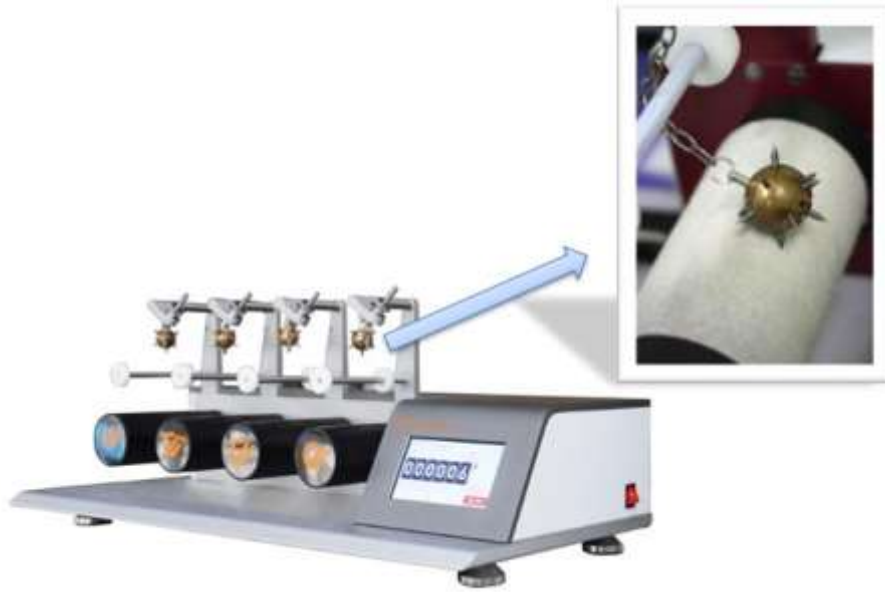
Şekil 4. Mace metodu kullanan cihaz ve metotta kullanılan gürzler (Testex, 2025)
