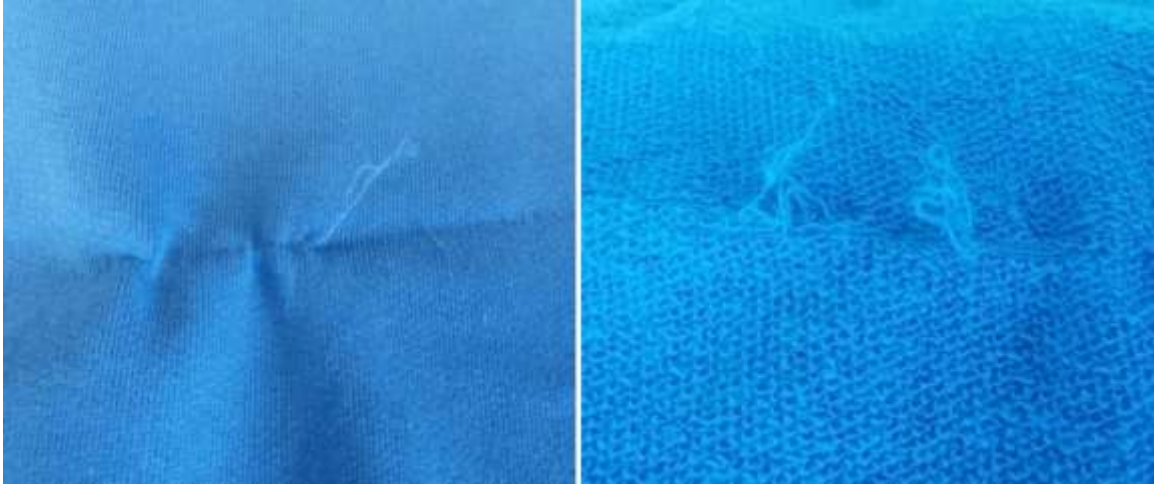
Şekil 3. İplik çekilmesi hatası örnekleri (Kertmen, 2019)
