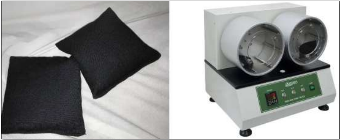
Şekil 5. Bean Bag metodu kullanan cihaz ve metotta kullanılan 450g \pm 10g ağırlığındaki torbalar (Roaches, 2025)
