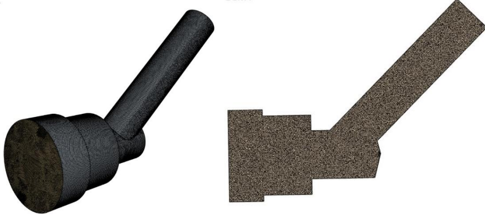
Şekil 5. 45° bağlantı elemanının sayısal çözüm ağı yapısı.
