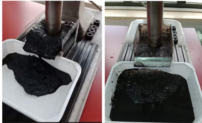
Şekil 2. Müzret kömürüne ait flotasyon görüntüsü (soldaki resim), Dikenli kömürüne ait flotasyon görüntüsü (sağdaki resim)
