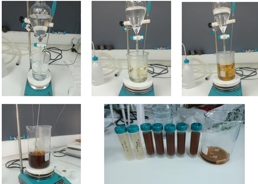
Şekil 1. Gümüş nanoparçacıkların sentez evreleri
