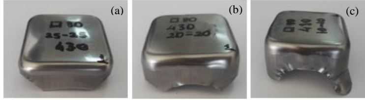
Şekil 7. Derin çekme işlemi uygulanan farklı alanlardaki ((a) 5150 \text{ mm}^2 , (b) 5600 \text{ mm}^2 ve (c) 6200 \text{ mm}^2 ) numuneler
