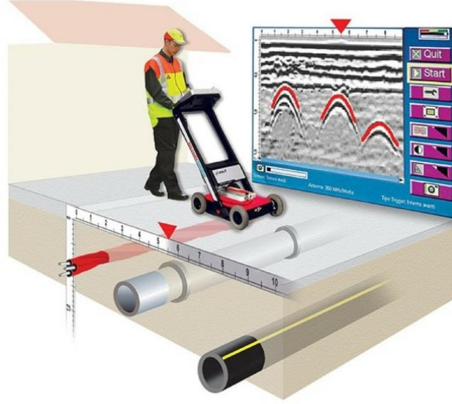
Şekil 2. Altyapı çalışmaları için Yer radarı yönteminin kullanımı ve radargram (URL-1)
