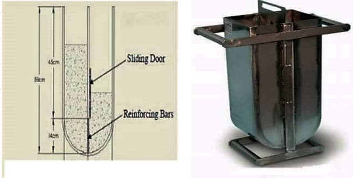
Şekil 5. U Kutusu Aparatı ve Uygulama Prensibi
