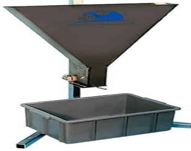
Şekil 3. V Hunisi Deney Aparatı
