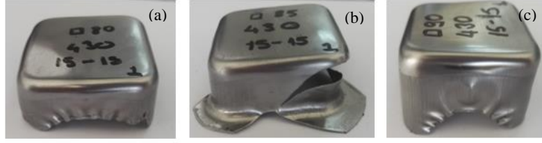
Şekil 9. Derin çekme işlemi uygulanan (a) 80 mm, (b) 85 mm ve (c) 90 mm kenar uzunluğuna sahip numuneler
