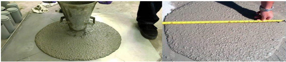
Şekil 2. Çökme Deneyi Aparatı ve Yayılma Ölçümü
