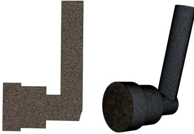
Şekil 6. 90° bağlantı elemanının sayısal çözüm ağı yapısı.
