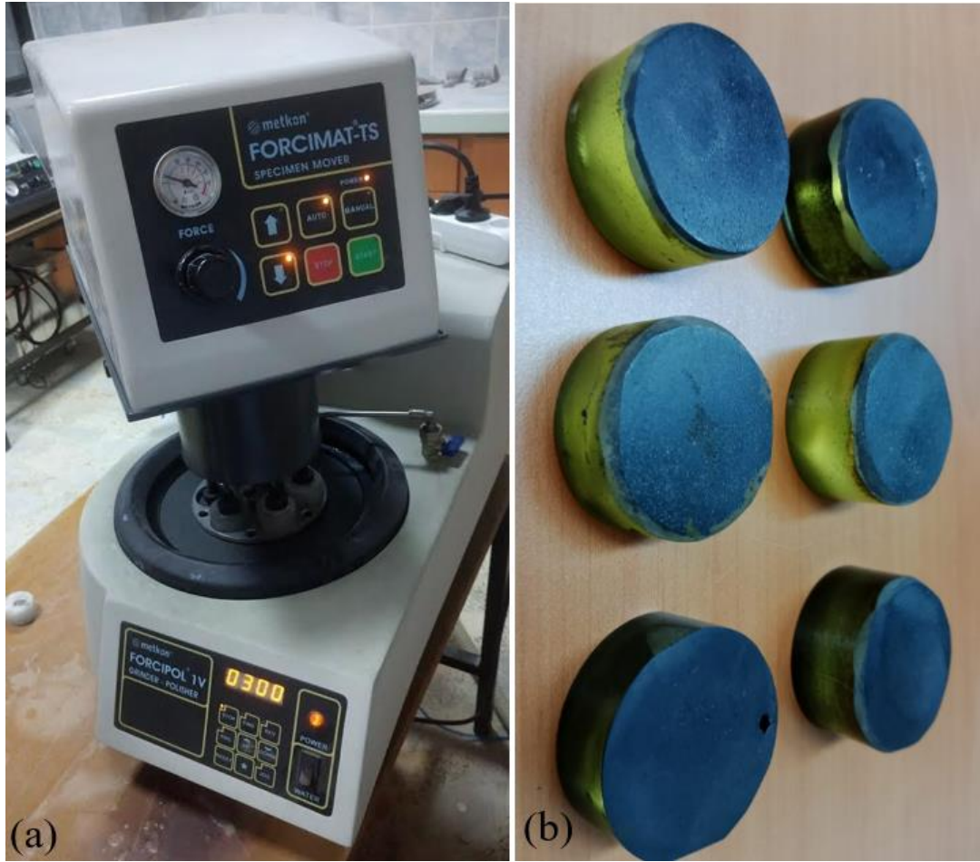
Őekil 1. Parlatma cihazı (a) ve hazırlanan kömür örnekleri (b)
