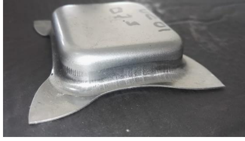
Şekil 4. Derin çekme işlemi uygulanan Erdemir 6112 (DC01) numune
